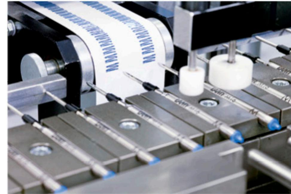
Wer schreibt, bleibt: die Lamy-Großraum-Mine M 16 bei der Qualitätsprüfung während des Fertigungsprozesses.
